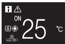
L'intervallo dei setpoint predefinito è 16°C~32°C. Se vengono impostati limiti a questo intervallo mediante l'apposita funzione dell'intervallo dei setpoint (funzione dell'app Madoka Assistant; vedere "Intervallo dei setpoint" [▶ 117]), è possibile solo aumentare o diminuire il setpoint per impostare i limiti massimi/minimi dell'intervallo.
